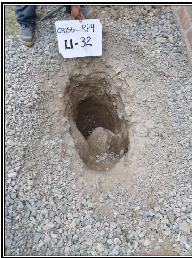
Foto N° 3 y 4: Ubicación de la calicata LI-32 se presenta un material removido conformado por arenas limosas, con raíces y gravas angulosas de 1" aisladas en un espesor de 0.50m, subyaciendo hasta la profundidad explorada de 2.00m con arenas con limos de grano grueso, con gravas angulosas en un 25-30%, no plástica, de color beige, humedad, con gravas de ¾"-1½" en un 10%-15% y tamaño máximo 13", en estado semicompacto.
