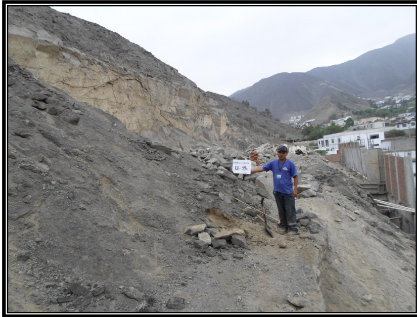
Foto N° 1 y 2: Ubicación de la calicata LI-31A se presenta un material removido conformado por arenas con gravas de 1/2" aisladas en un espesor de 0.10m, continuando hasta la profundidad de 0.30m con la roca intrusiva (granodiorita), en estado muy meteorizado y fracturado, al excavar se presenta como arenas gravosas, en estado compacto, subyaciendo hasta la profundidad explorada de 0.40m con la roca intrusiva (granodiorita), en estado sano de difícil excavación manual.
