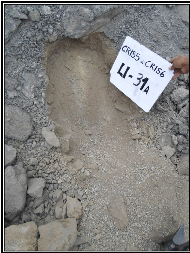
Foto N° 1 y 2: Ubicación de la calicata LI-31A se presenta un material removido conformado por arenas con gravas de 1/2" aisladas en un espesor de 0.10m, continuando hasta la profundidad de 0.30m con la roca intrusiva (granodiorita), en estado muy meteorizado y fracturado, al excavar se presenta como arenas gravosas, en estado compacto, subyaciendo hasta la profundidad explorada de 0.40m con la roca intrusiva (granodiorita), en estado sano de difícil excavación manual.
