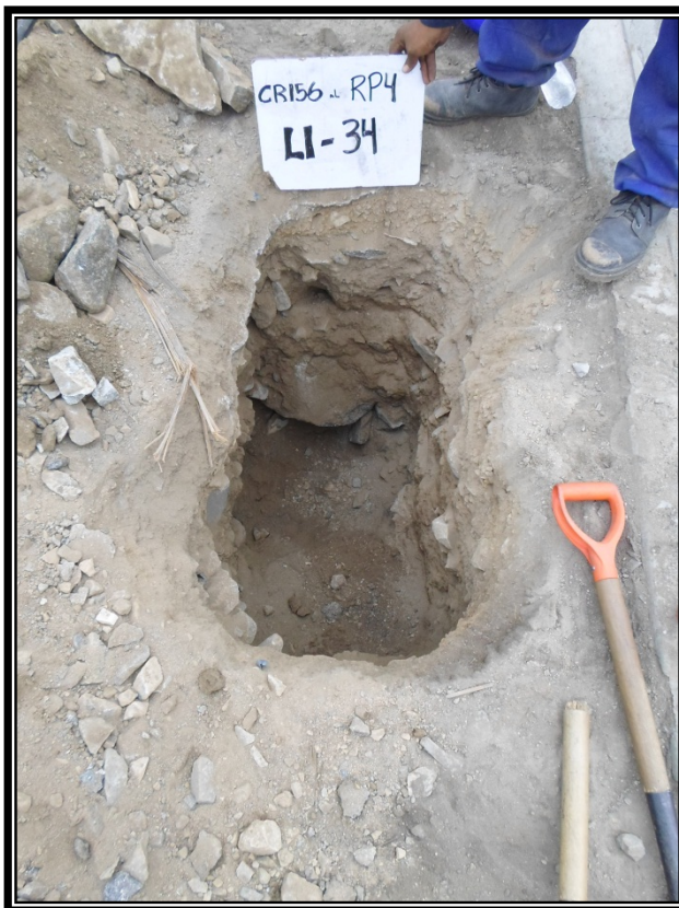
Foto N° 7 y 8: Ubicación de la calicata LI-34 se presenta un material de afirmado consistentes en gravas angulosas, con matriz limo arenoso, en estado semicompacto en un espesor de 0.20m, subyaciendo hasta la profundidad explorada de 2.00m con arenas con limos de grano grueso, con gravas angulosas en un 30-35%, no plástica, de color beige, poca humedad, con gravas de 1"-1½" en un 5%-10% y tamaño máximo 16", en estado semicompacto.
